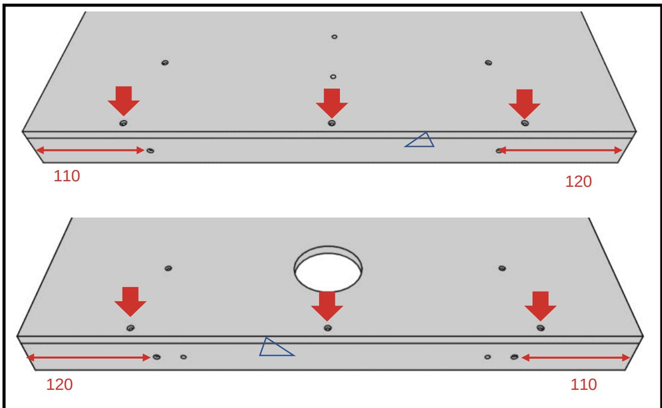
Abbildung 12: Ausrichtung und Position Längsleisten und Schraubenpositionen
