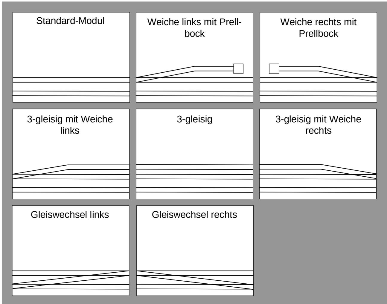
Abbildung 1: Modulvarianten
