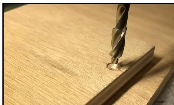
Abb. 5: Senken der Vorderseite mit dem Flachsenker
