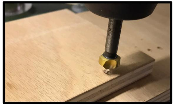
Abb. 6: Senken der Rückseite mit einem Kegelsenker
